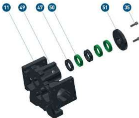
Рис. 529 - Детали по манжетному уплотнению
